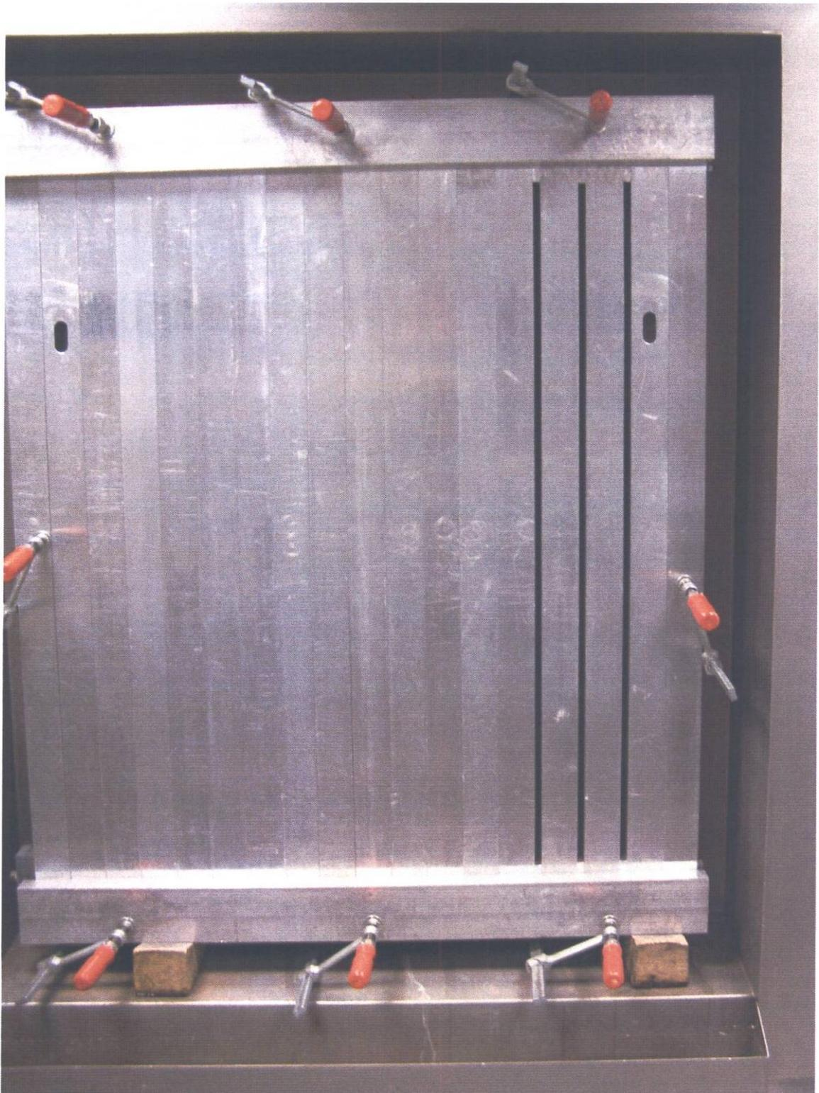
Bild 5: Versuchskörper, bestehend aus Hohlkammerprofilen (Querschnitt 60 mm x 100 mm) mit dazwischen befindlichen Fugen, in denen die Multifunktionsbandproben eingebaut sind.
